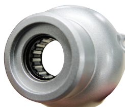
Nadellager an der Antriebswelle verringern Vibrationen und erhöhen die Lebensdauer.
